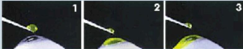
**Illustrations 1 - 3:** Comportement d'écoulement de liquides aqueux sur une surface en verre
