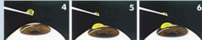
**Illustrations 4 - 6:** Comportement d'écoulement de liquides aqueux sur une surface en matière synthétique
